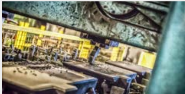
Bewerken van de oppervlakte van de gietijzeren tafels
