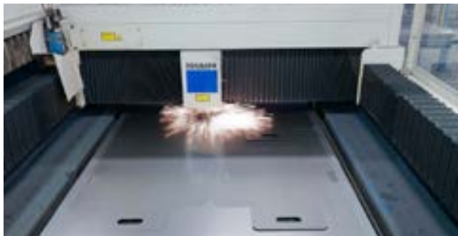
Uitlaseren van stalen plaatmateriaal
