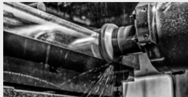
CNC gestuurde bewerkingen van de gietijzeren tafels
