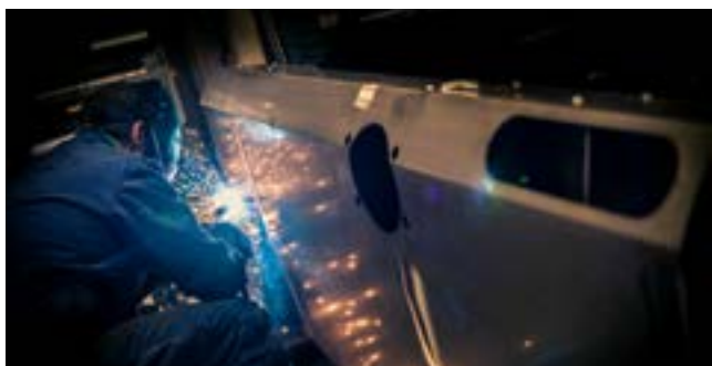
Lassen van een chassis
